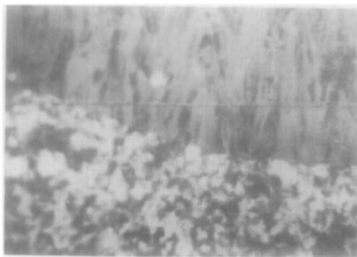
FIG. 5. Examen métallographique de la composition \text{GaSe}_4 . Mise en évidence d'une démixtion liquide-liquide.
